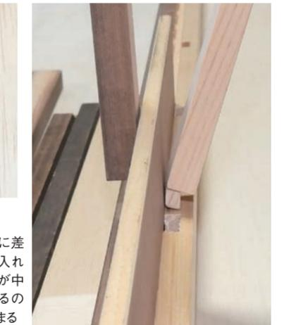
写真5 杓子柄を斜めに差し込みながら入れ込むと、柄穴が中で広がっているのでもっと納まる
