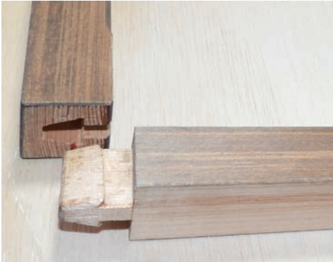
写真6 框と上下棧の仕口 鎌柄と呼ばれる形状の仕口加工
