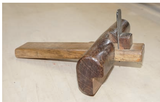
図7 割罫引き（わりけびき） 木材に線を引いたり薄板を割ったりする道具 （研修の最初に製作する）
